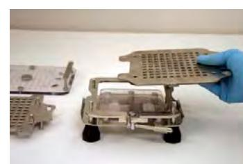
5. Heben Sie die durchsichtige Distanzplatte, um sie mit der Distanzplatte in der neuen Größe zu ersetzen.
