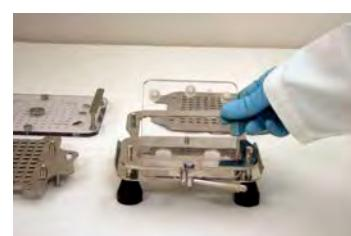
4. Stellen Sie den Betätigungshebel auf die 3-Uhr-Position. Entfernen Sie die 3 Blechsätze.
