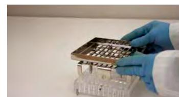
2. Platzieren Sie die neue Vorsortierer-Platte und sichern Sie sie mit 2 Rändelschrauben.
