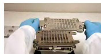
3. Entfernen Sie die Kapsel-einsatzplatte.
