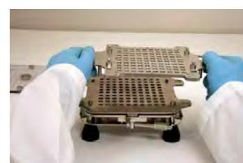
6. Platzieren Sie den Blechsatz in der neuen Größe: „a“, „b“ und schließlich „c“ auf die Positionierlöcher.
