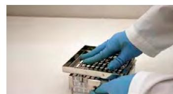
1. Lösen Sie die beiden Rändelschrauben, die die Vorsortierer-Platte auf dem Boden festhalten.
