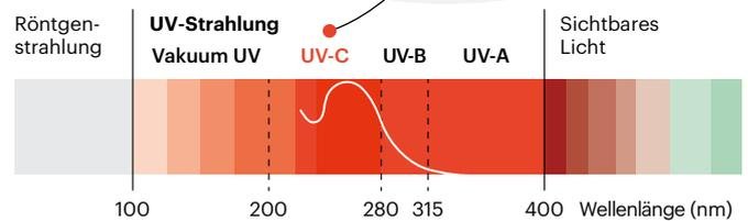
Die keimtötende Wirkung des UVC Lichtes ist nachweislich im Bereich einer Wellenlänge von 240 - 280 nm am effektivsten. Die UVC-Lampen des UVGI-80 erreichen eine Wellenlänge von 253,7 nm.
