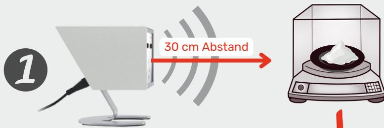
Den ION-e mit max. 30 cm Abstand zur Analysenwaage plazieren , einschalten und anschließend Spironolacton abwiegen.
